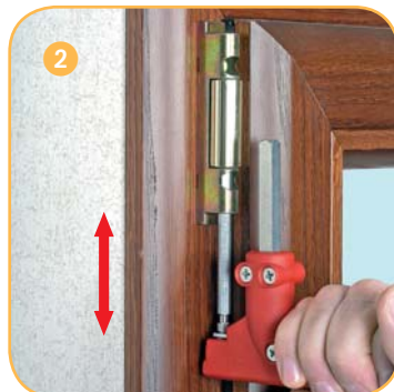
Inserimento ed estrazione del perno dal supporto forbice con inserto.
