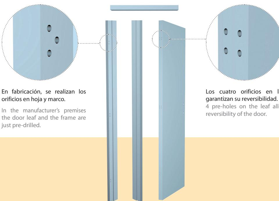
En fabricación, se realizan los orificios en hoja y marco.
