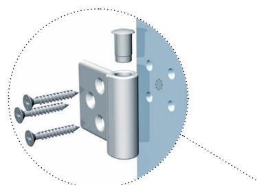
La aleta de la bisagra está pensada para esconder los orificios del lado no utilizado.
