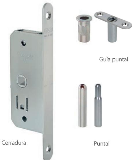
El frontal de la cerradura es liso y no lleva pestillo, ni pasador o gancho alguno. El bloqueo de la hoja se realiza por el puntal, montado sobre la barra roscada que tiene un recorrido de 30 mm y se acciona por rotación de 180° del cuadradillo del tirador.
