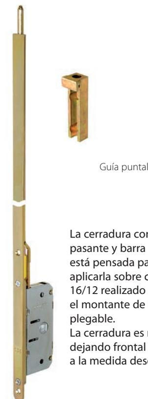
La cerradura con frontal pasante y barra móvil está pensada para aplicarla sobre canal 16/12 realizado sobre el montante de la hoja plegable. La cerradura es recortable dejando frontal y puntal a la medida deseada.
