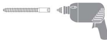
Gracias a su cabeza hexagonal, el tirafondo se puede colocar con un atornillador común antes de fijar el retenedor mediante un prisionero.
