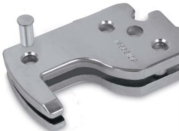
El gancho está compuesto por dos placas de acero templado unidas por un pasador. Su geometría permite la regulación lateral de la hoja mientras se garantiza un anclaje al soporte a prueba de forzamientos.
