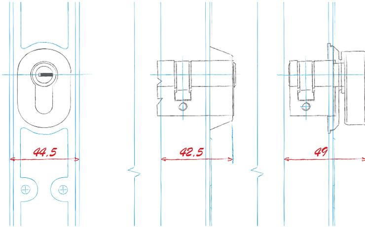
Una anchura de 44,5 mm y un fondo de 42,5 mm (49 mm con pomo) permiten el montaje de la cerradura en cerramientos con montantes estrechos, por ej., perfiles de aluminio o aquellos en los que la contraventana y la ventana o balconera están muy próximas.
