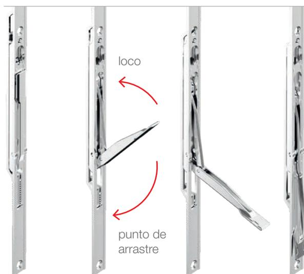
El pasador pasante con leva frontal garantiza la función antivandalismo de la ventana de dos hojas. Si se arranca el nudo central, la leva no puede ser accionada tirando desde el exterior: la hoja en posición de cierre impide el movimiento de la leva. El movimiento frontal permite además ejercer una fuerza mayor para mover los múltiples puntos de cierre de la hoja pasiva.
