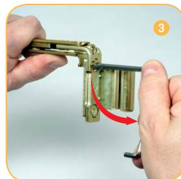
Ensamblaje del ángulo del compás con la llave allen de 4 mm.
