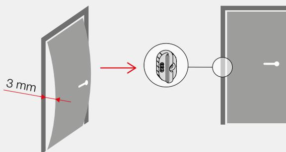
El pico evita las deformaciones de la puerta provocadas por la humedad o la gran altura de la puerta, recuperando hasta 3 mm. El pico también es compatible con: Minimal Plus, Alutop y Easy-Fix.
