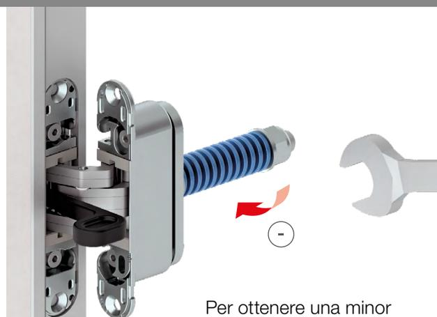
Per ottenere una minor forza di chiusura, ruotare il dado in senso orario per scaricare la molla.
