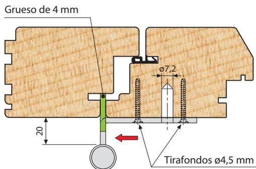
**2** Fijación con tirafondos  $\varnothing 4,5$  mm.
