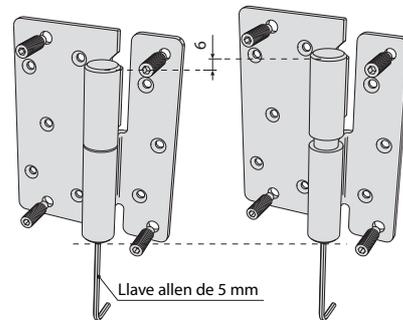
**REGULABLE:** en altura gracias a la regulación inferior situada en el cuerpo de la bisagra, que permite una elevación vertical de 6 mm.
