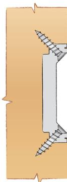
Крепится при помощи запатентованной системы AGB 3,5 мм шурупами скрытыми внутри выемки ответной части.
