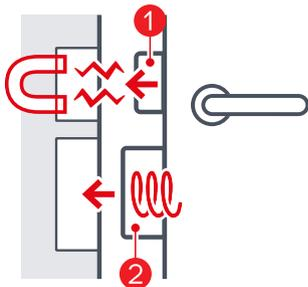
Магнитный привод защелки создает новый стандарт тишины при закрывании двери.
