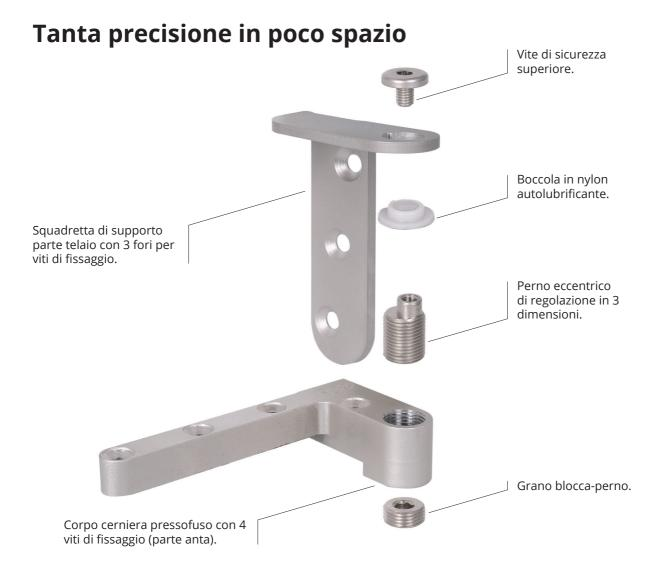
Il perno della cerniera consente la regolazione in tre dimensioni a porta montata.
