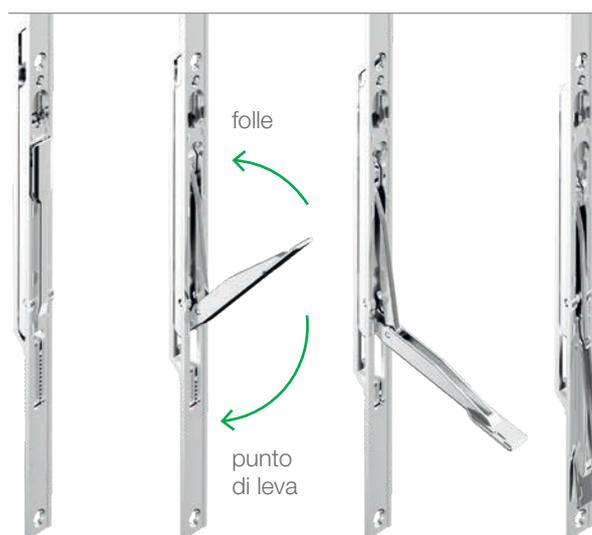
Il catenaccio passante con leva frontale garantisce la funzione antieffrazione della finestra a due ante. Se viene strappato il montantino a riportare, la leva non può essere aperta tirandola dall'esterno: l'anta battente chiusa impedisce la movimentazione della leva.
