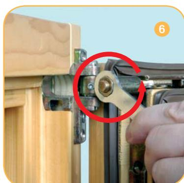
Regolazione orizzontale della forbice  $\varnothing 34$  con chiave esagonale da 13 mm (4 mm a tirare per aria 4 e 7,5 mm a tirare per aria 12).
