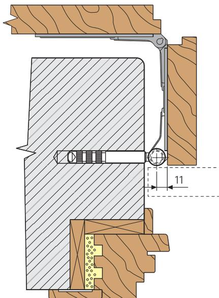
Per la realizzazione del sistema "alla Mestrina", la cerniera va utilizzata in abbinamento alle bandelle H00952.XX.XX, alle cerniere a snodo tipo H00931.09.XX ed alle bandelle H00920.XX.XX.
