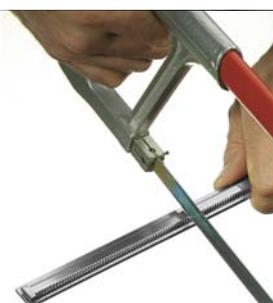
Le estremità delle aste Sicurtop sono facilmente rasabili per adattare la serratura all'altezza dell'anta.
