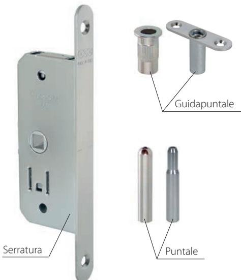
Il frontale della serratura è liscio e non presenta alcuno scrocco, catenaccio o gancio. Il bloccaggio dell'anta avviene mediante un puntale, montato su un'asta filettata avente corsa di 30 mm e azionata dalla rotazione di 180° del quadro maniglia.
