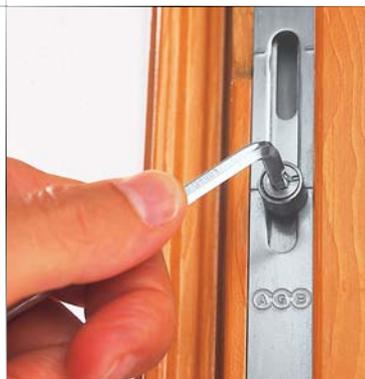
Nottolini cilindrici con regolazione ad eccentrico, consentono di uniformare la pressione sulle guarnizioni. I nottolini sono in acciaio stampato a freddo, con guaina girevole anti-attrito in ottone. Si regolano con una chiave esagonale da 4 mm.
