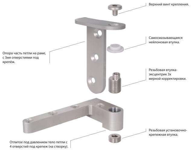
Эксцентричная втулка позволяет настройку В 3х измерениях, когда дверь установлена.
